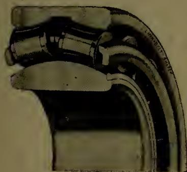
Os mancais de rolos anti-fricção das séries "DE", como o que se vê na gravura acima, são unidades independentes, (completas em si) e de ajustamento adequado para a fábrica, não exigindo adaptações especiais para sua montagem. Suas qualidades de auto-compensação e pre-ajustamento dispensam o recurso ao emprego de armações dispendiosas, inconvenientes e cheias de transtornos. A auto-compensação propicia ao mancal uma certa flutuação axial, de modo a compensar a expansão do eixo.
