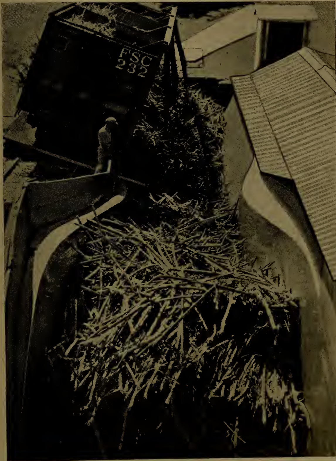
Um basculador hidráulico Link-Belt cambando cana para um alimentador Link-Belt, que abastece a esteira principal, em caminho para as moendas. Perspectiva do tandem "A". No tandem "B" há duplicação. Companhia Azucarera Fidelidad, S. A.
