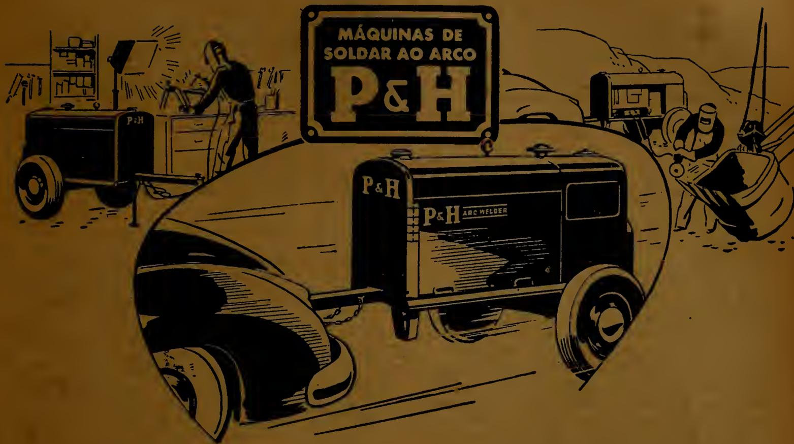
Esta máquina de soldar P&H de reboque é de menor preço e de funcionamento mais econômico. De fácil transporte para qualquer parte, ela é acionada pelo seu próprio motor a gasolina de 4 cilindros, de modo que se pode soldar na oficina ou no local do trabalho. Um único controle torna mais fácil o uso desta máquina de soldar ao arco. O modelo WN-200 tem uma capacidade de 30 a 260 ampères. O equipamento padrão desta máquina de soldar de reboque inclui uma tomada de corrente alter-
