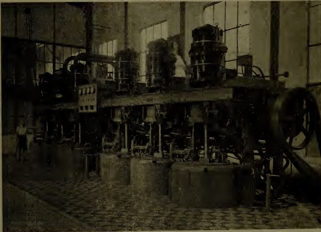
Bateria de 6 centrifugas automáticas "Fives Lille", de 1.500 ou 1.800 r.p.m. e 25 descargas por hora
