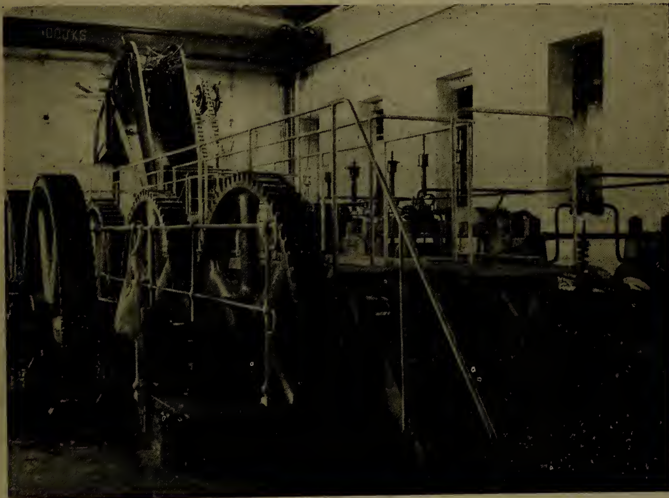
USINA N. S. APARECIDA Moenda de 17 rolos, 18 x 30", montada em 1937
