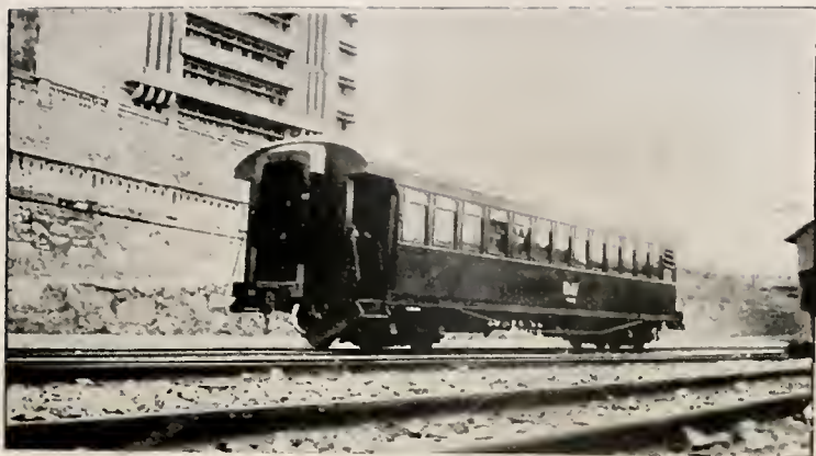
Carro de passageiros, de 1. a classe, construído nas oficinas de Lavras, da Rede Mineira de Viação
