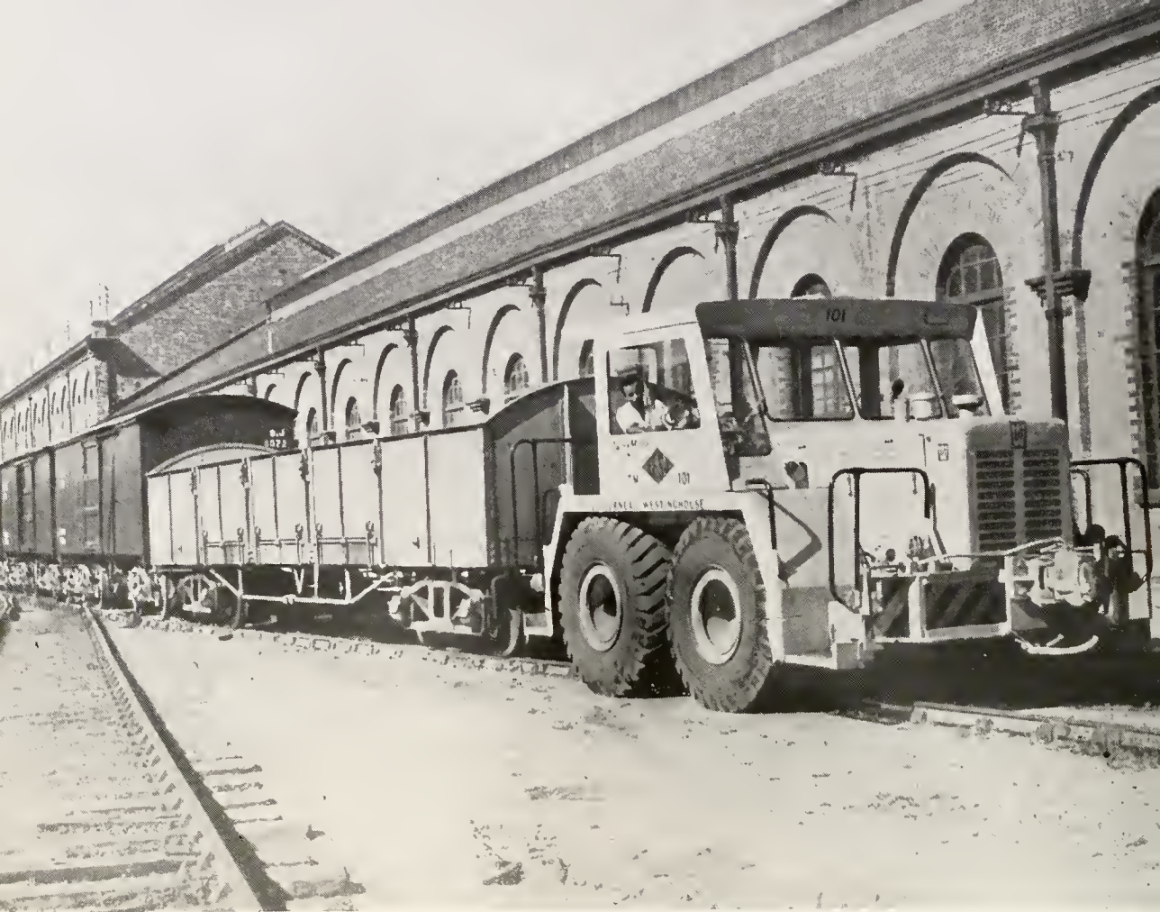
Reequipamento dos pátios de manobras — Switch Mobile operando no Pátio de Lapa E. F. S. J.
