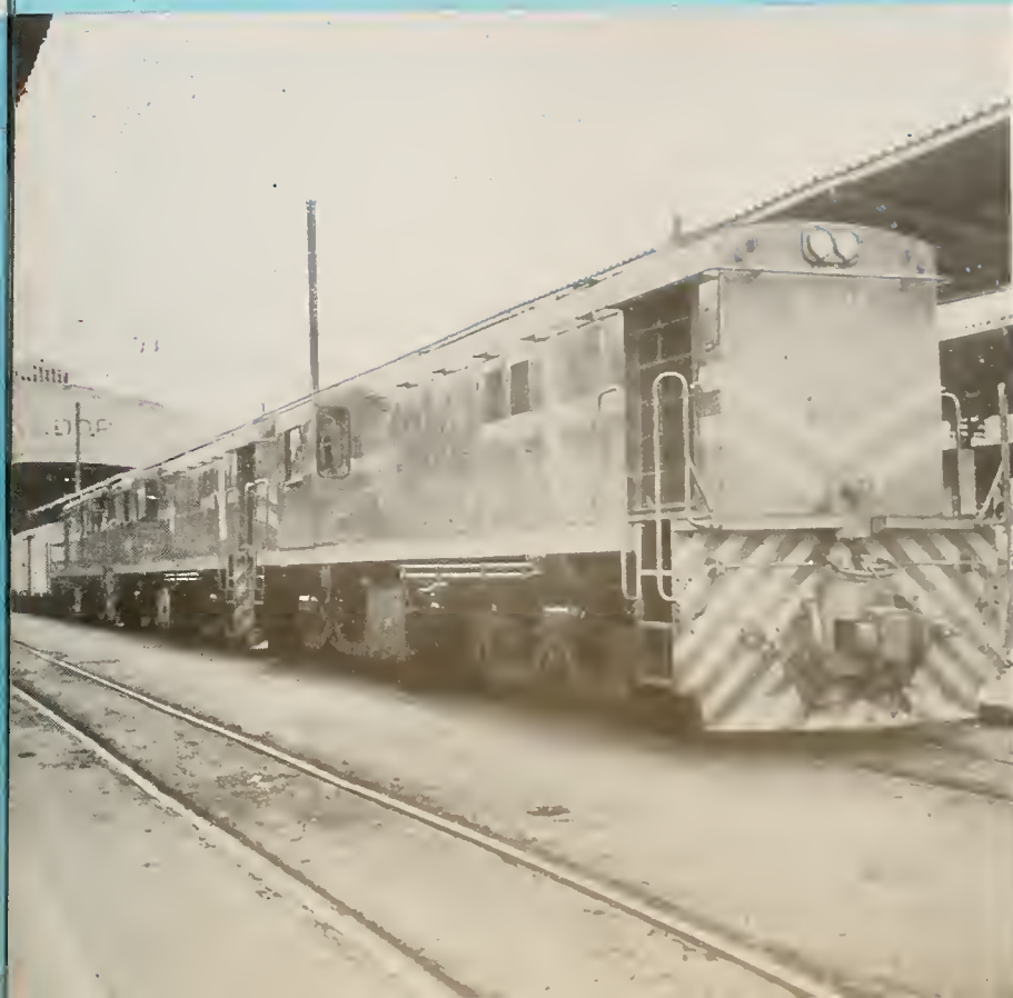
Dieselização da tração — Três das dez locomotivas Diesel-elétricas adquiridas para a V.F.F. Leste Brasileiro.
