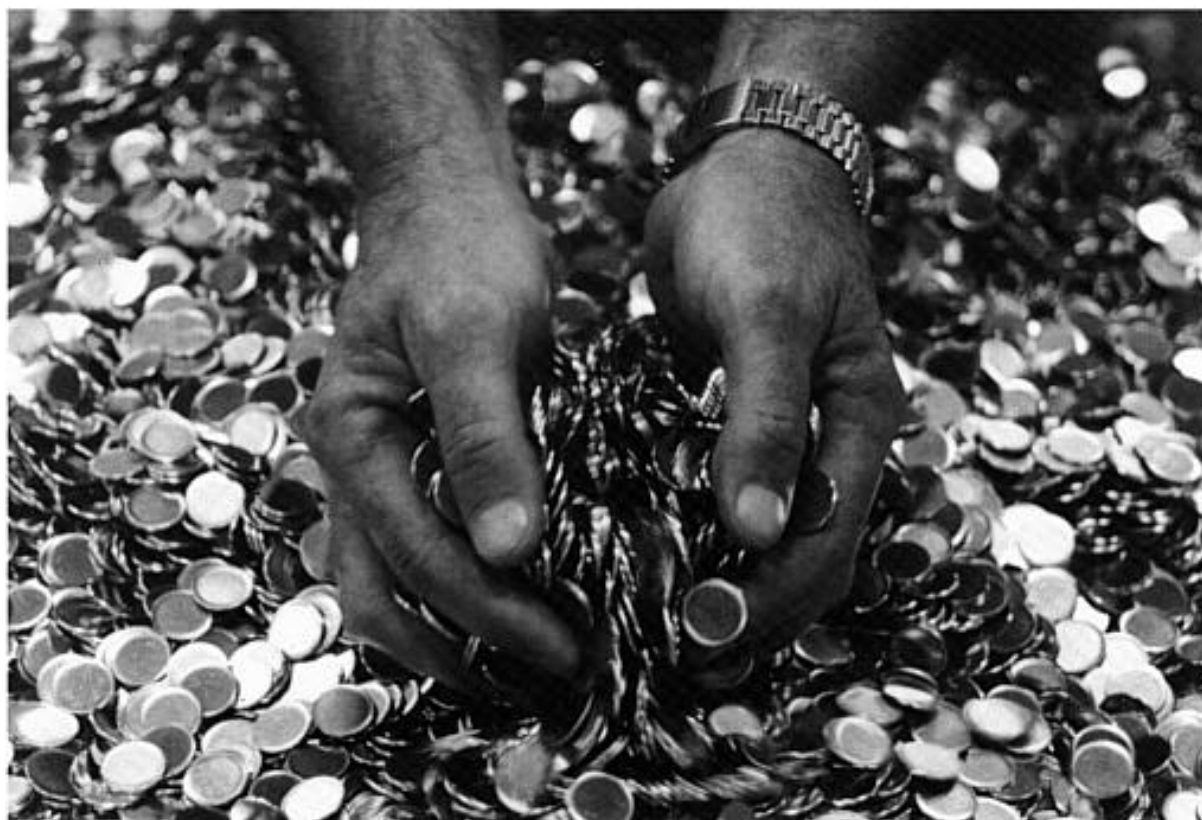
“Discos de aço a serem cunhados” Foto - Departamento de Moedas e Medalhas Casa da Moeda do Brasil
