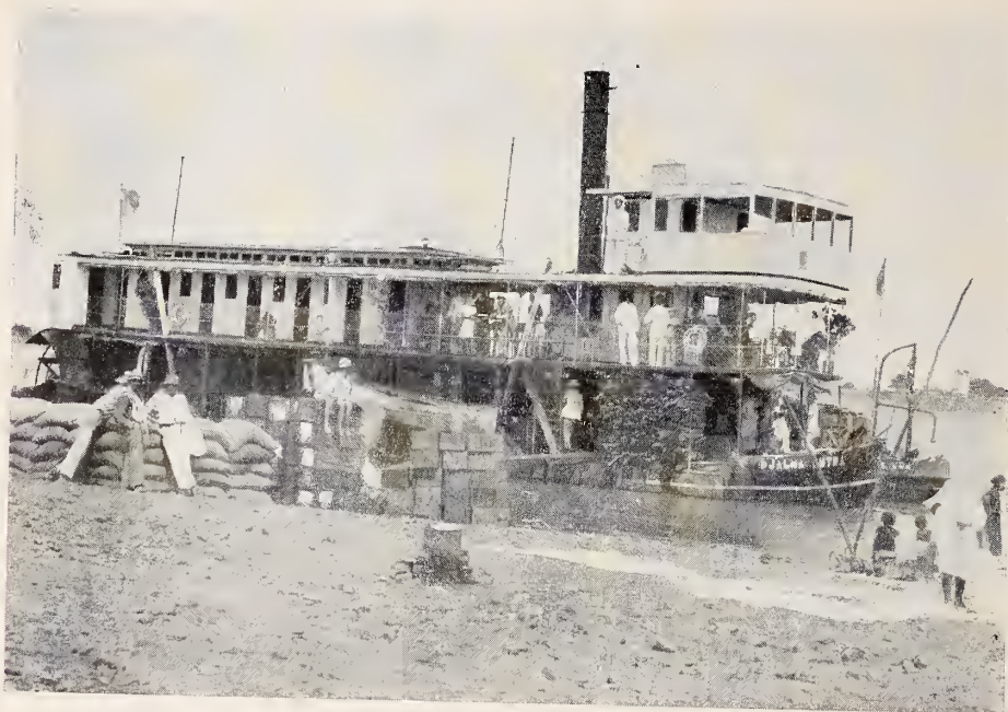
Fig. 65 — Vapor do rio São Francisco, tipo médio — Calado, carregado: 1,30 metro
